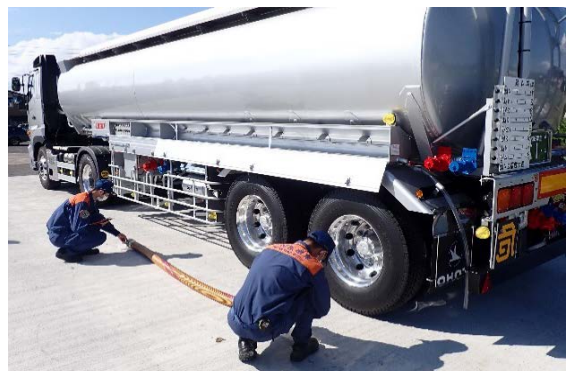
移動タンク貯蔵所完成検査
